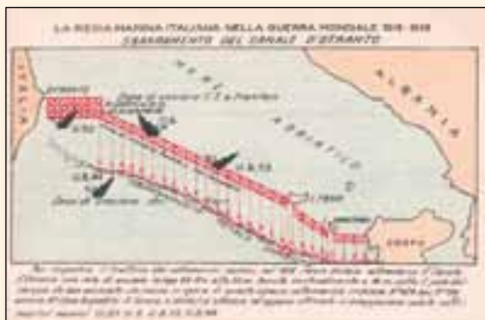
Cartolina emessa dallo Stato Maggiore Marina che mostra lo sbarramento del Canale d'Otranto con una rete antisommergibili metallica profonda 50 metri e lunga 66 chilometri. Quattro sommergibili austriaci si trovarono impigliati in essa, nel tempo
