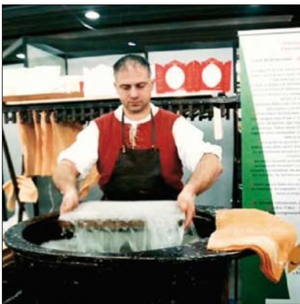
Il Mastro Tiberi filtra, attraverso un setaccio, l'acqua emulsionata con la cellulosa per ricavare un foglio di carta
